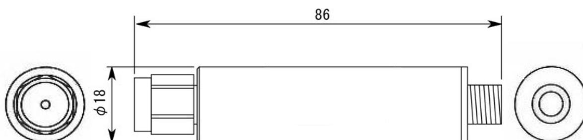
オーリング搭載の防水構造となっておりますが、屋外取り付け時には付属の専用防水キャップ等での防水処理をお薦めします。
